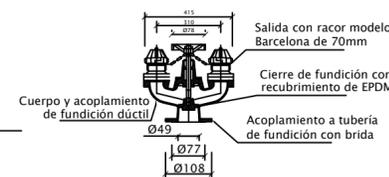
ALZADO SECCION FRONTAL (1/10)
